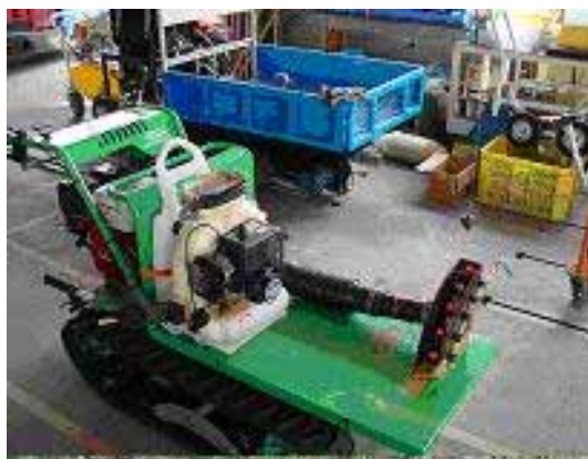
第4図 超小型スピードスプレーヤー試作1号機
